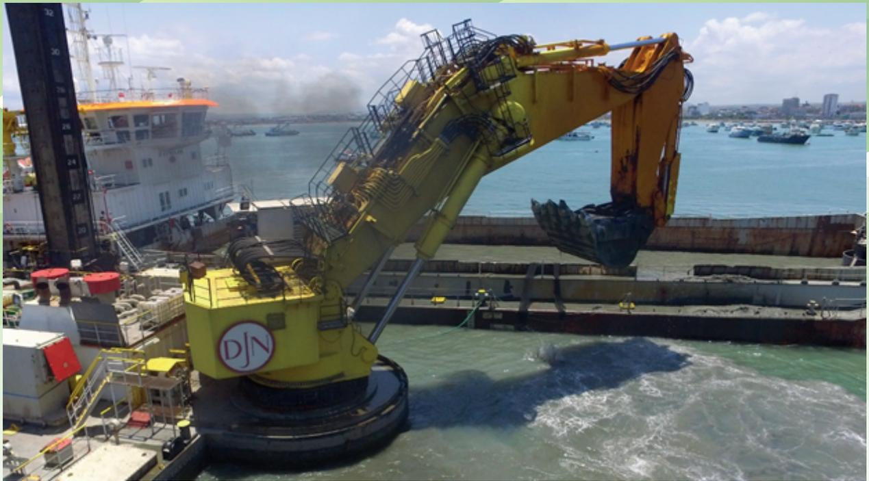
*Fiscalización del dragado del Terminal Portuario de Manta, (TPM), obra que permitió profundizar el área del canal de acceso, área de maniobra y de los muelles hasta los 12,5 metros de profundidad del MLWS. Fiscalización ejecutada para TPM 2017.*
