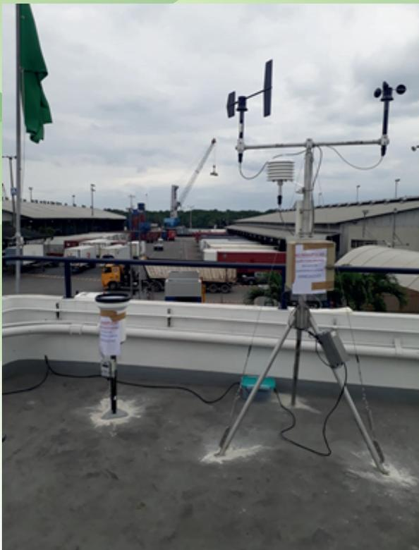
*Estación meteorológica: incluye sensores de temperatura, vientos (dirección y velocidad) y pluviómetro*
